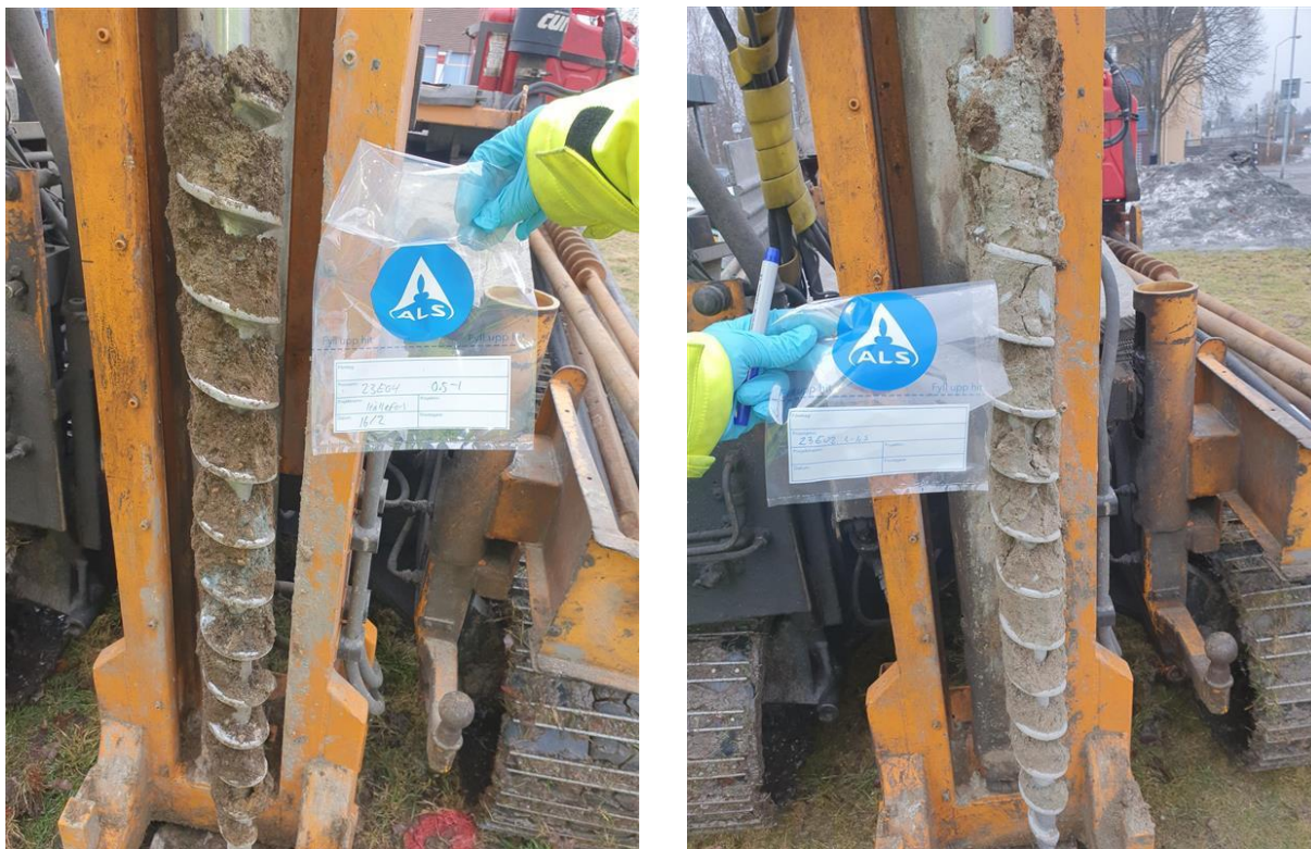
Figur 5. Till vänster, skruvborr som visar 0 – 1 meter från provpunkt 23E_04. Till höger, skruvborr som visar 1 – 2 meter från provpunkt 23E_03.
